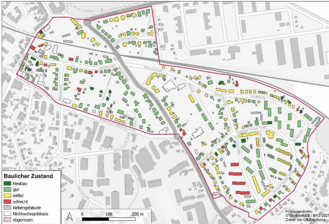
Abbildung 102: Baulicher Zustand Wohngebäude
